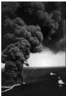
Slika 3. NOBE eksperimenti požarnog procesa ( Newfoundland Offshore Burn Experiment ).
