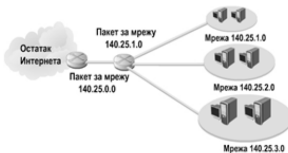
Слика 3: LAN IP рутерско адресирање
