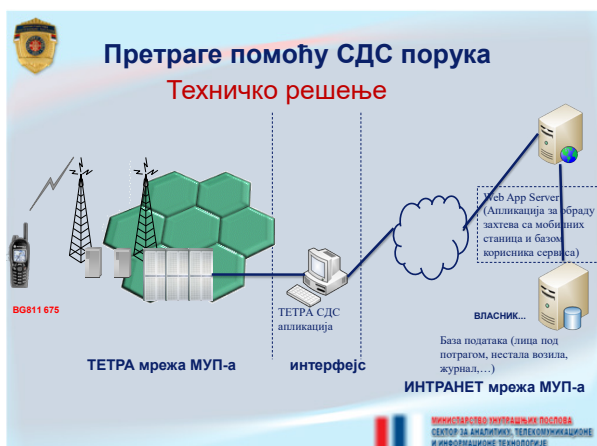
Слика 7. Решење „Претраге помоћу СДС порука“
