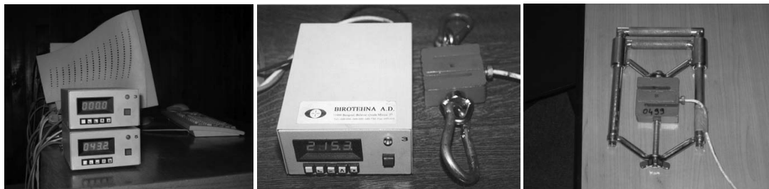
Слика 1: Тензиометријска сонда са дигиталним показивачем силе и конструкцијом за процену силе стиска шаке
