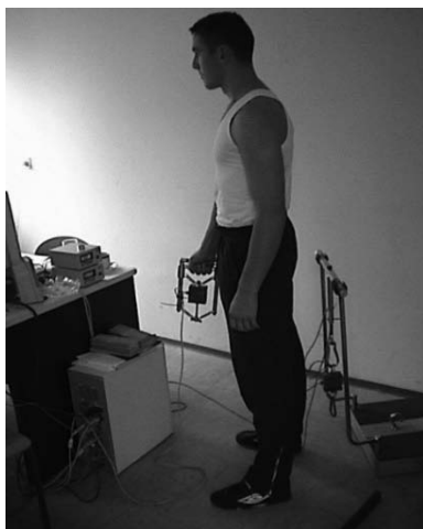
Слика 4: Процедура, опрема и позиција мерења контрактилних карактеристика мишића прегибача прстију шаке
