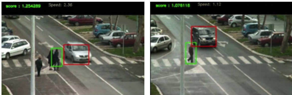
Слике 3 и 4. Пример детекције кретања пешака и возила, пешачки прелаз у Београду
