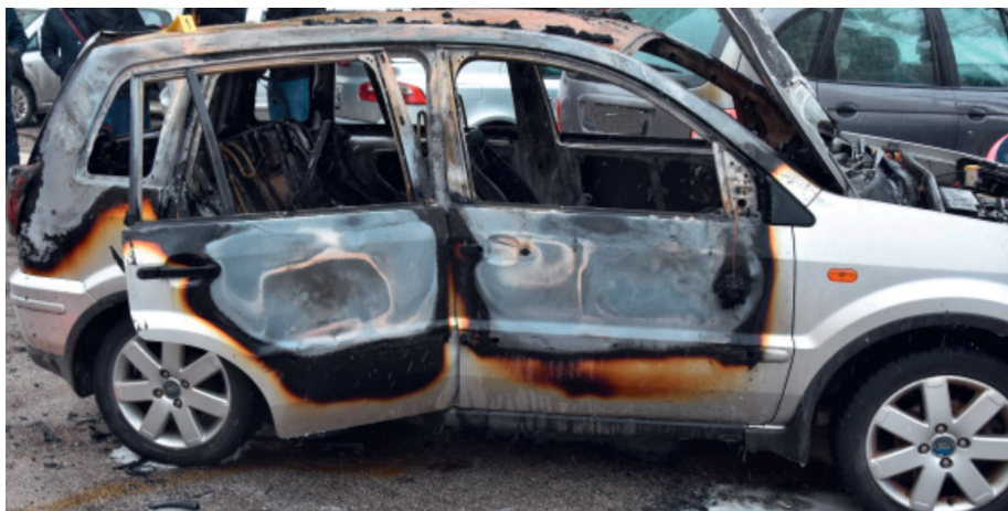
Фотографија 7. Изглед бочне стране возила у ком је дошло до самозапаљења услед квара на инсталацији грејача у возачевом седишту
