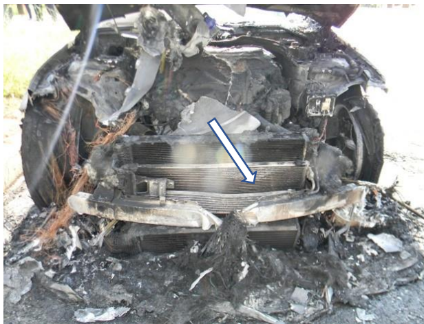
Фотографија 8: Оштећење на средини металног браника као последица локалног дејства поспешивача горења у виду "левка"
