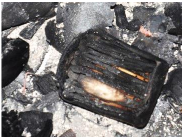
Фотографија 1: Цигарета у шибици у функцији одложеног иницирања пожара.
