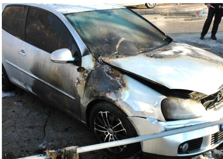
Фотографија 5: Плочасто пуцање и раслојавање ветробранског стакла као последица кратке и бурне реакције запаљеног поспешивача горења
