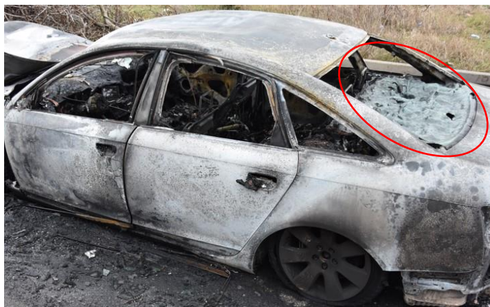
Фотографија 7: Задње стакло истог возила, затечено у потпуно другачијем стању (затопљено) од предњег ветробранског стакла, као последица равномерног загревања и без утицаја бурне реакције поспешивача горења
