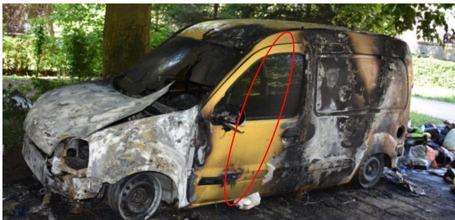
Фотографија 3: Јасно видљива граница између два центра пожара
